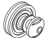
6. Ролик для крепления полотна
